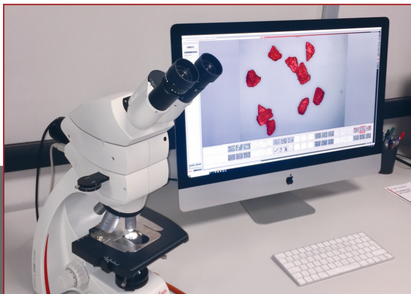
Analisi di immagine presso il PoliLab: verifica e confronto delle polveri di diamante Image analysis at PoliLab: verification and comparison of diamond powders
