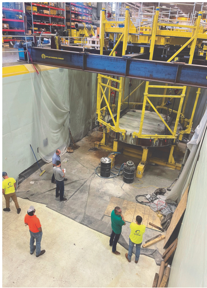
Piattaforma MPRV definitiva e supporti delle pulegge montati sul modello del recipiente del reattore Final MPRV platform and pulley supports in-place over reactor vessel mock-up
