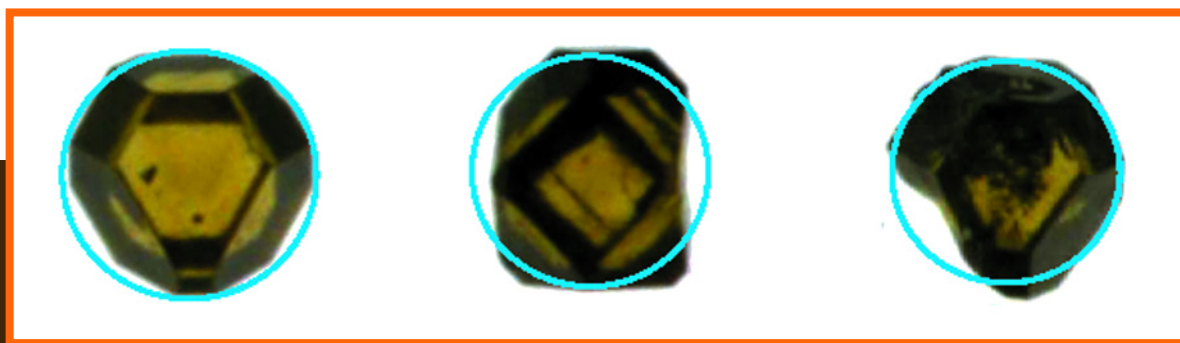
Fig.4 Schema della compattezza, con particelle di diamante cristalline (a sinistra), di forma allungata (al centro) e meno cristalline (a destra) Schematic illusion of compactness, with highly crystalline (left), elongated (centre) and less crystalline (right) diamond particles
