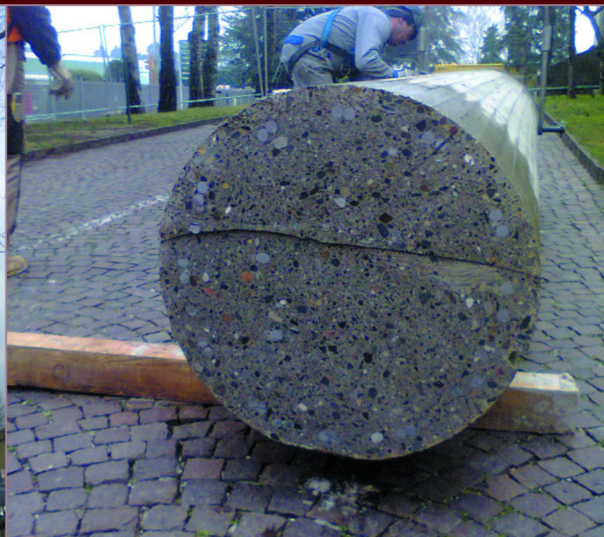
8. Particolare del pilastro sezionato Detail of the sawed pillar
