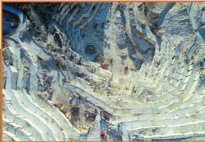
**Fig.1a** Foto aerea della Cava Michelangelo; è chiaramente visibile la configurazione a gradino diritto per fette orizzontali discendenti
