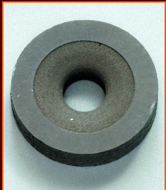
**Fig.4** Ceramico conduttivo a matrice  $\text{Si}_3\text{N}_4$  dopo la sinterizzazione SPS e la modellatura con elettroerosione EDM (perforazione, taglio)
