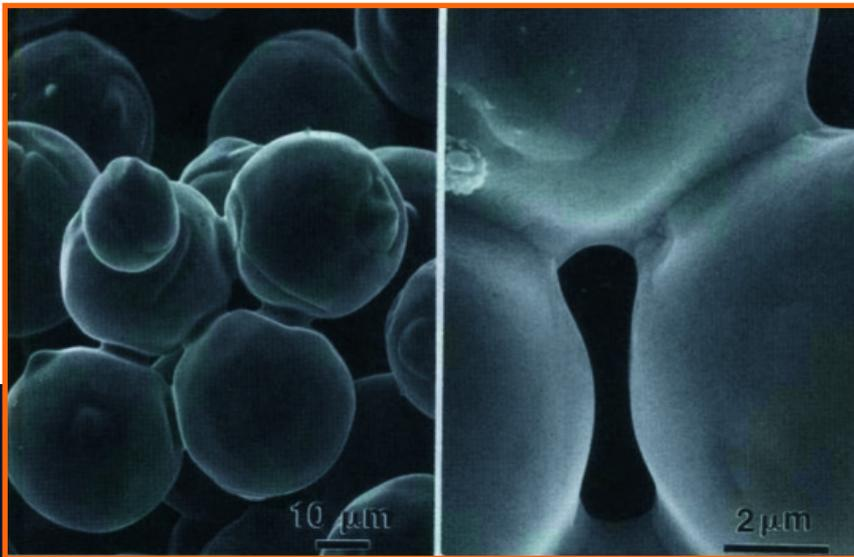
**Fig.1** Esempio di adesione con formazione di giunzioni di materiale tra due o più particelle in corrispondenza del loro punto di contatto / *Example of adhesion with formation of material junctions between two or more particles at their point of contact*
