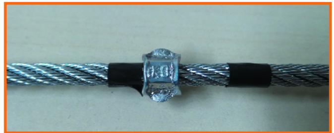
Fig.4 Pressatore compresso sulla fune
