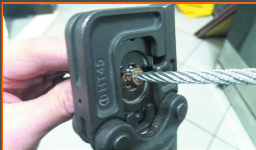
**Fig.8** Compressione di un morsetto di giunzione sul cavo eseguendo una doppia pressata in uno stesso punto del morsetto ruotandolo di 90 gradi (operazione eseguita in 4 punti della giunzione) per l'esecuzione di prove di rottura a trazione
