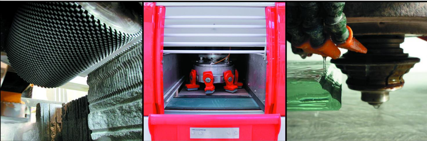
Esempi di utensile con diamante sintetico in polvere per taglio e sagomatura
