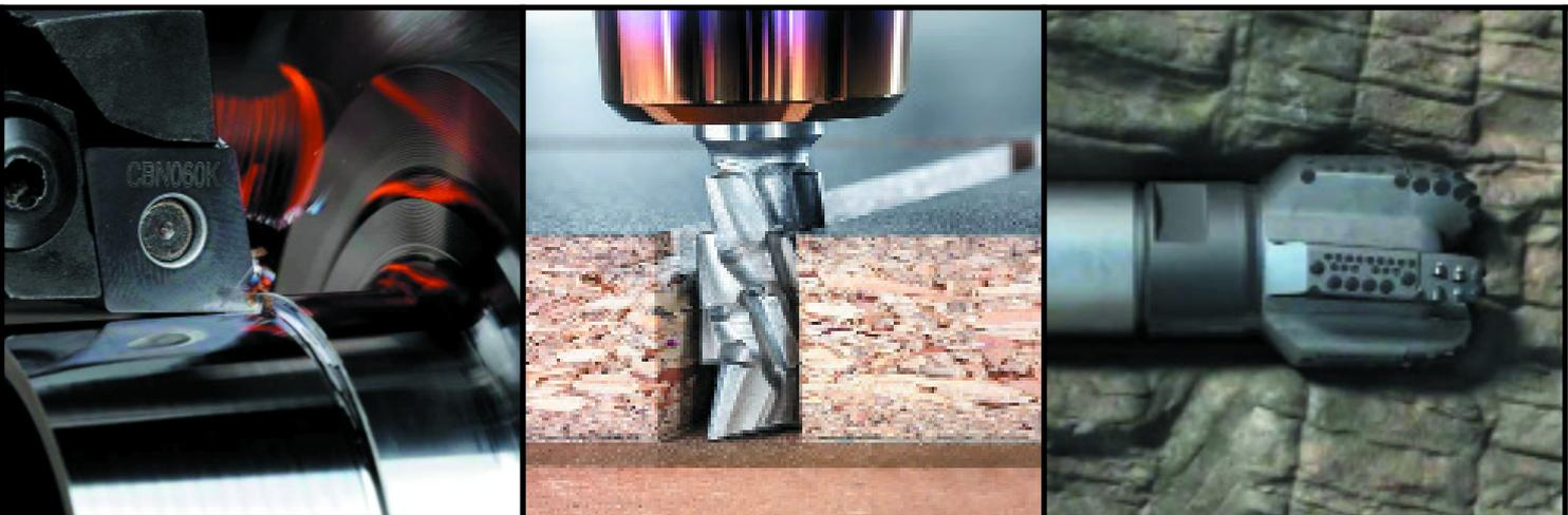
Esempi di utensile con taglienti in PCD e PCBN per asportazione di truciolo e perforazione
