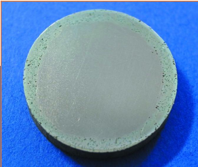
**Fig.3** Aspetto di un materiale a gradiente di funzione a base rame con abrasivo SiC prodotto con sinterizzazione/colata centrifuga
