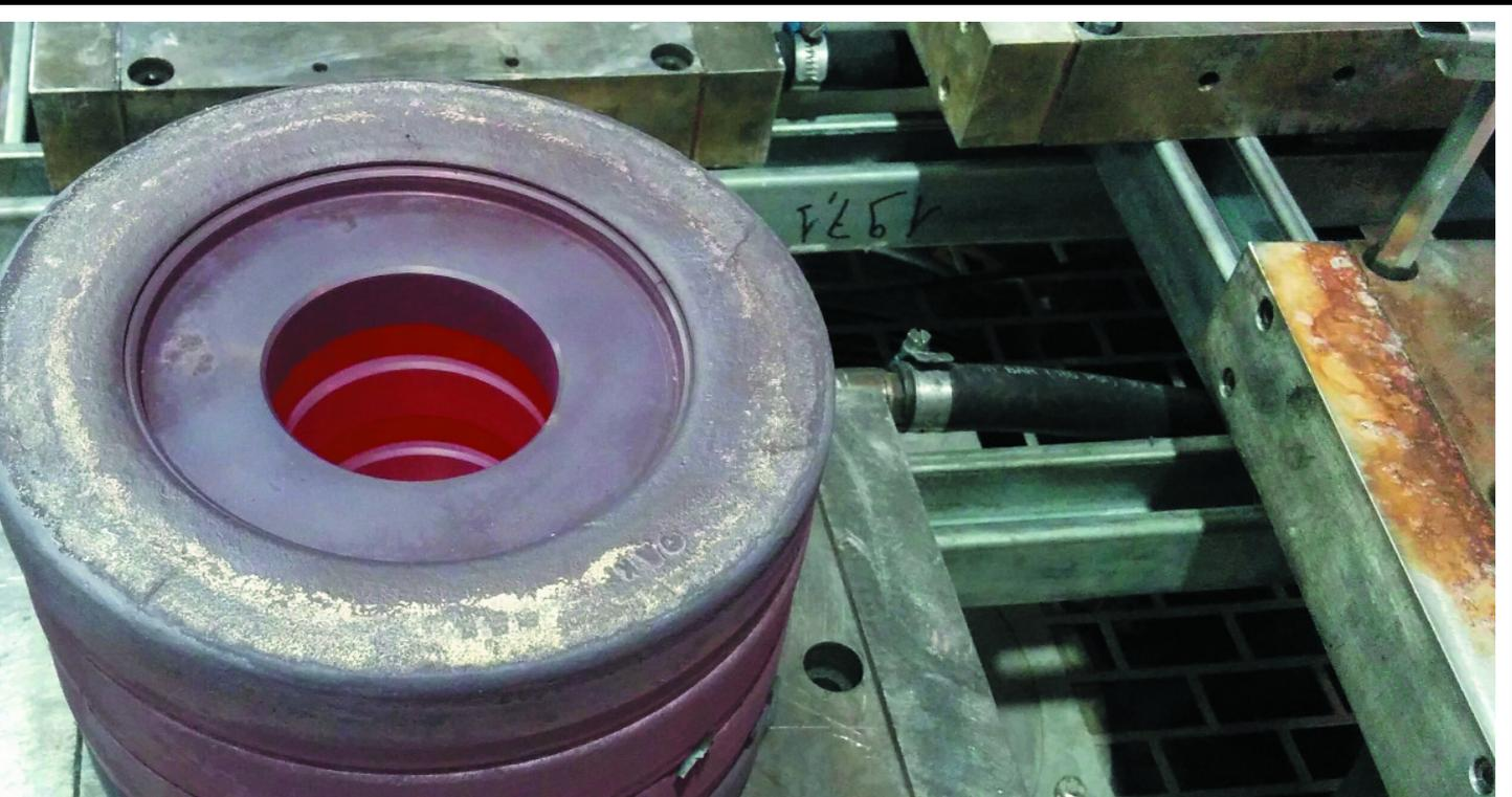
Area interna di una mola diamantata alla fine del ciclo di sinterizzazione ad induzione / *Diamond wheels internal area at the end of the induction sintering process*
