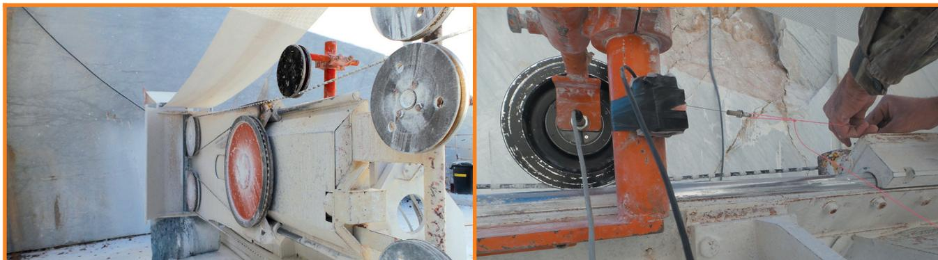
Fig.9 A sinistra, posizionamento cella di carico sull'Apuania Corsi MF 5000; a destra, installazione dell'estensimetro a filo
