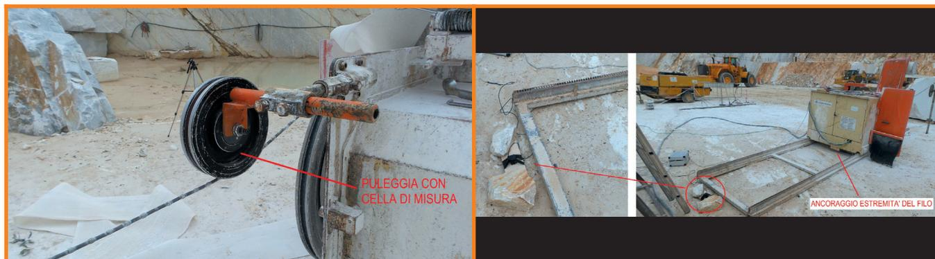
Fig.15 A sinistra, posizionamento della cella di carico; a destra, installazione dell'estensimetro a filo
