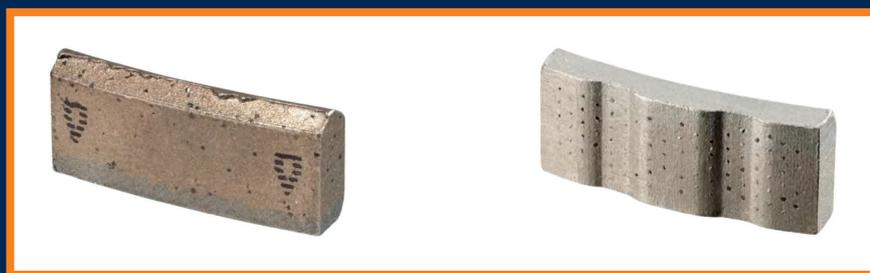
Fig.3 Foto di segmenti impregnati di diamante nel carotaggio del calcestruzzo armato: con grani di diamante distribuiti casualmente (sinistra) e con diamanti posizionati (destra)
