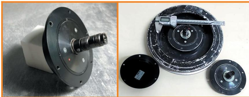
**Fig.2** Rullo rilevatore di forza RMGZ 400 B. Forza nominale: 500 N. Dimensioni:  $d_1$  85 mm,  $d_2$  100 mm,  $d_3$  110 mm -  $l_1$  6.5 mm,  $l_2$  4 mm,  $l_3$  13 mm. Limite di velocità 8500  $\text{min}^{-1}$ , coefficiente di carico  $C_{dyn}$  11.8 kN, peso 0.75 kg, sensibilità 1.8 mV/V, classe di precisione  $\pm 0.1\%$ , resistenza in ingresso 350  $\Omega$
