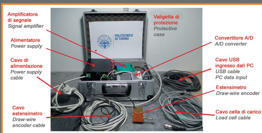
Fig.7 Valigetta di protezione degli strumenti e cavi di collegamento
