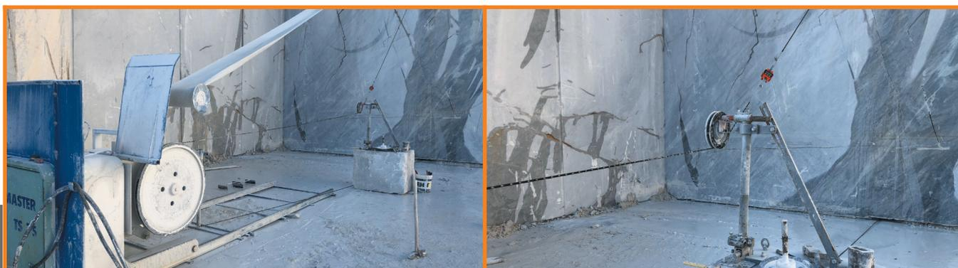
**Fig.25** Taratura del taglio al monte in configurazione 2, dinamometro su lato superiore del filo / *Upstream cut calibration according to layout 2, dynamometer on the upper side of the wire*
