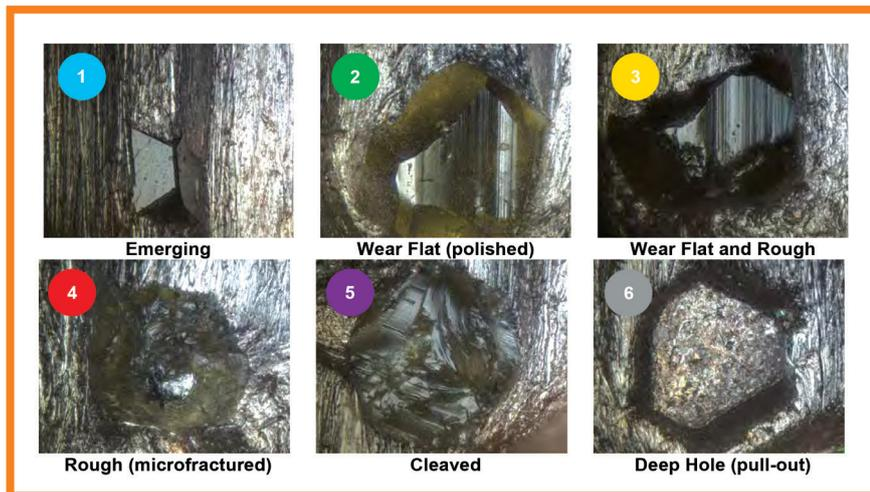
Fig.1 Sei stati di usura nel ciclo di vita di una particella di diamante nel carotaggio del calcestruzzo
